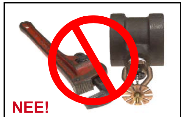
Afbeelding 4: Onjuiste montagesleutel (ESFR sprinkler getoond met pijptang)
