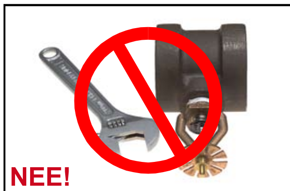
Afbeelding 3: Onjuiste montagesleutel (ESFR sprinkler getoond met crescent wrench)
