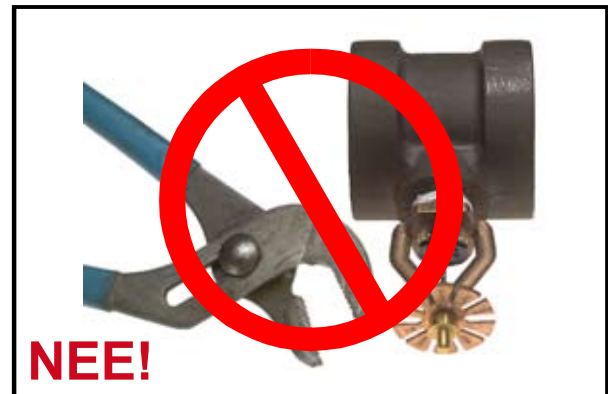
Afbeelding 2: Onjuiste montagesleutel (ESFR sprinkler getoond met channel locks)
