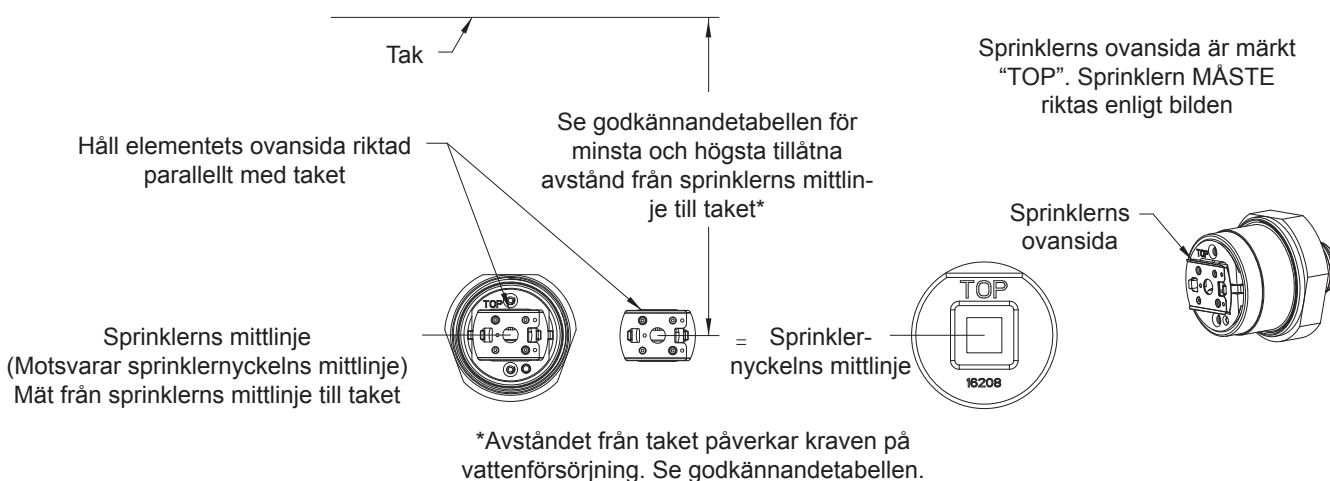
Bild 3: Sprinkler VK480 korrekt riktning för spridarplatta
