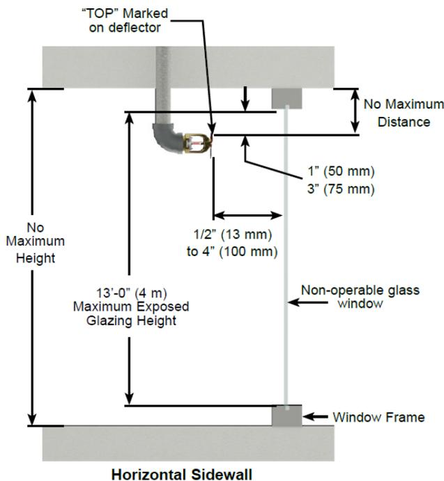
**FIGURE 3—HORIZONTAL SIDEWALL SPRINKLER INSTALLATION**
