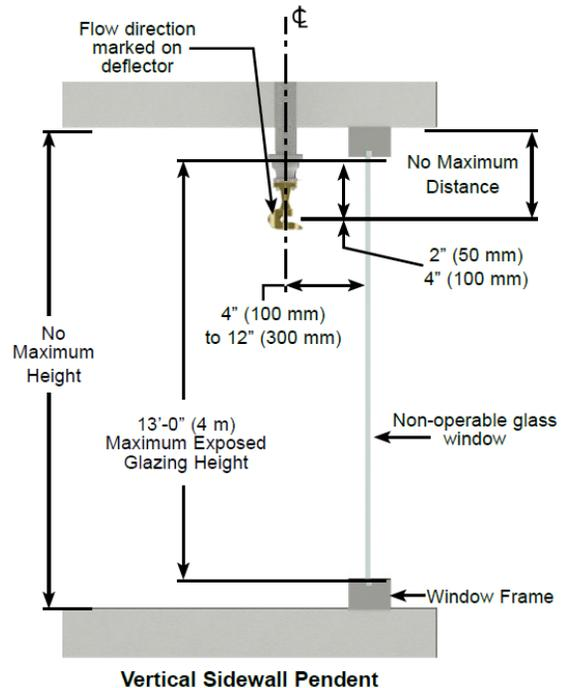
**FIGURE 4—PENDENT VERTICAL SIDEWALL SPRINKLER INSTALLATION**
